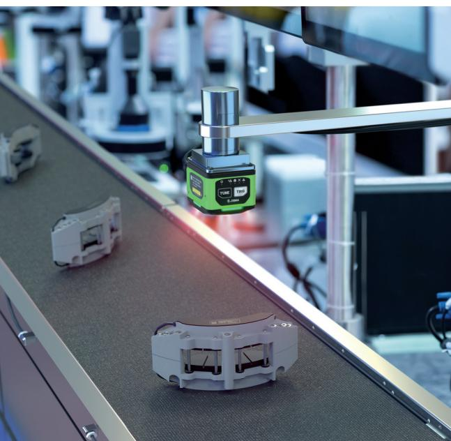
**Zavedli jsme pokročilý systém identifikace přepravních vozíků prostřednictvím fixních snímačů Zebra FS40, které společnost Magna používá jako součást automatizovaného procesu kontroly kvality dílů pro montáž.**
